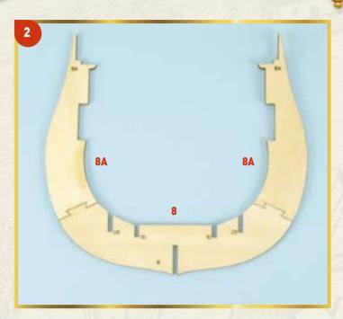
2 Соберите шестой шпангоут. Для этого склейте его нижнюю часть (8) и топтимберсы (8A) небольшим количеством клея, руководствуясь инструкцией выпуска 2.
